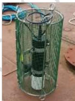
Figure 23 : Sonde SAMBAT avec cage de protection (Source : EPOC)
