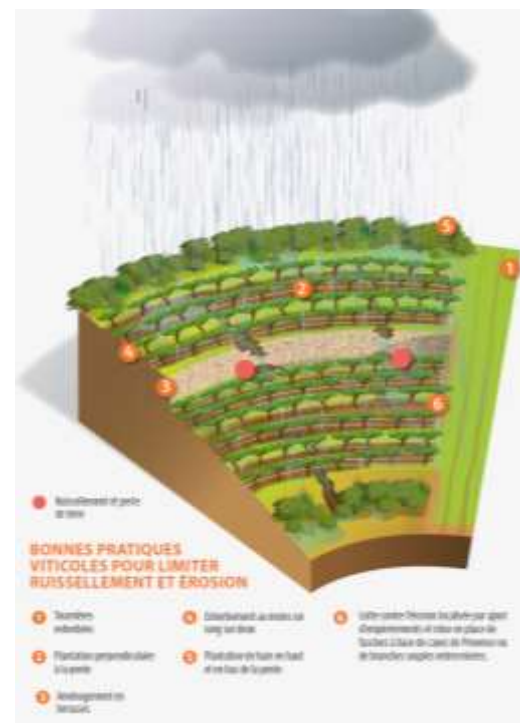
Figure 31 : Bonnes pratiques viticoles pour limiter ruissellement et érosion (Source : CA83)
